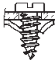
Agujero de roscado de compresión, necesidad de útil especial
